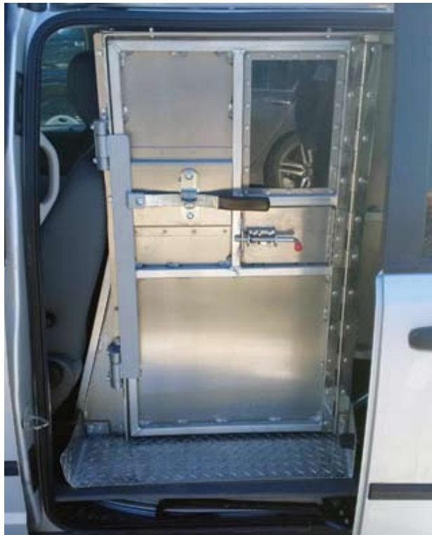
Une porte métallique d'une fourgonnette de transport des détenus.
